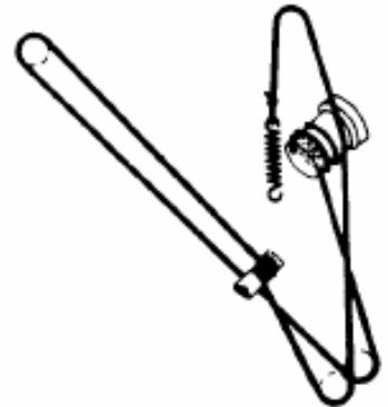
SCHEMA DELLA TRASMISSIONE DEL COMANDO DI SINTONIA. UNITÀ IN POSIZIONE DI MASSIMA INDUTTANZA.
